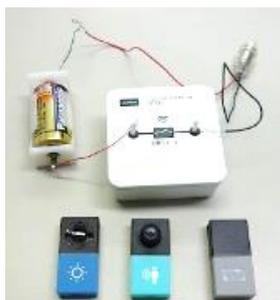
⑥MESH (SONY) (スイッチ、人感センサー、明るさセンサー、GPIO)
